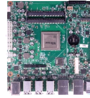
MITX-6553HY 基于飞腾D2000 处理器 的嵌入式工业主板
