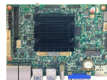
EMB-3581 基于Rockchip RK3568处理器的3.5" 嵌入式工业主板
