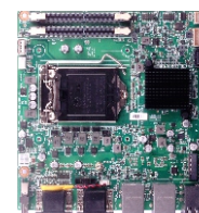
MITX-6138 基于Intel 10代 Core i3/i5/i7/i9 LGA1200处理器的嵌入式工业主板
