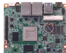
EMB-2582 基于Rockchip RK3588处理器的2.5" 嵌入式工业主板
