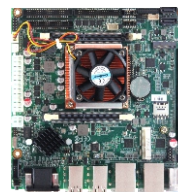
MITX-6553 基于飞腾FT-2000/4(四核), 处理器的嵌入式工业主板
