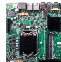
MITX-6139 基于Intel 10代 Core i3/i5/i7/i9 LGA1200 65W处理器 的嵌入式工业主板
