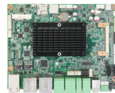
EMB-7536 基于Rockchip RK3399 处理器的嵌入式工业主板
