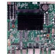
MITX-6122 基于Intel Alder Lake-N 处理器的嵌入式工业主板
