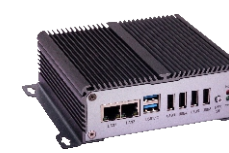
BIS-6620K-A10 基于Intel Celeron J6412处理器的嵌入式准系统
