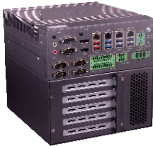
BIS-6960M-A10FI 基于Intel 10代 Core i3/i5/i7/i9 LGA1200处理器的嵌入式准系统
