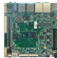
EMB-3512 基于NXPi.MX8M Plus处理器的 嵌入式工业主板
