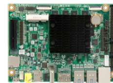
EMB-3531 基于Rockchip Rk3399 处理器的嵌入式工业主板
