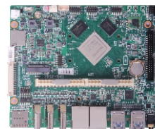
EMB-3582 基于Rockchip RK3588 处理器 的3.5" 嵌入式工业主板
