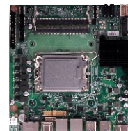
MITX-6155 基于Intel12/13/14代Core i3/i5/i7 处理器的嵌入式工业主板
